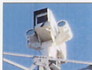
近赤外線監視カメラ (55倍ズームレンズ、近赤外線照射500W×2灯)
